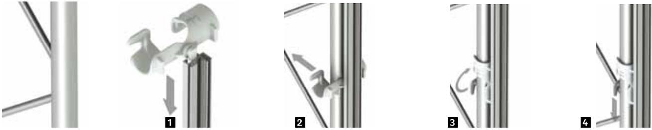
Stoffprofil 01 wird auf Profilkammer für Stoff montiert Die Klammer wird auf die Traverse gedreht und auf eine Strebe geschoben. Der Profilrahmen ist dann bereit, um mit dem Stoff bedeckt zu werden.
